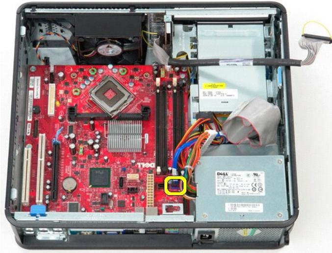
12. Desconecte el cable de alimentación del procesador de la placa base.
