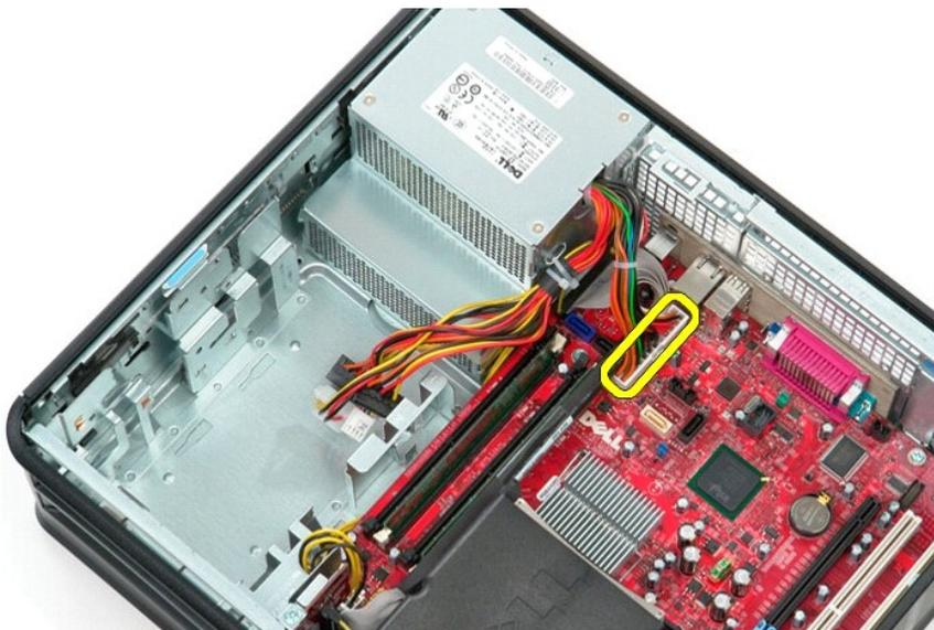
5. Desconecte el conector de alimentación del procesador de la placa base.
