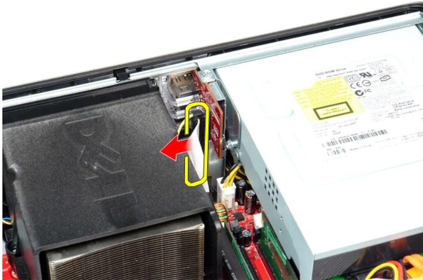
3. Retire el tornillo que fija el panel de E/S al chasis.
