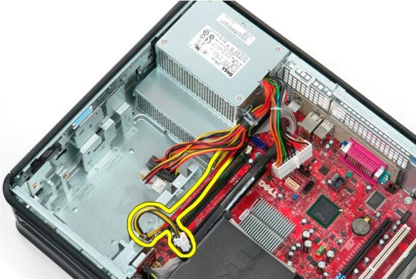
7. Retire los tornillos que fijan la fuente de alimentación a la parte posterior del chasis.
