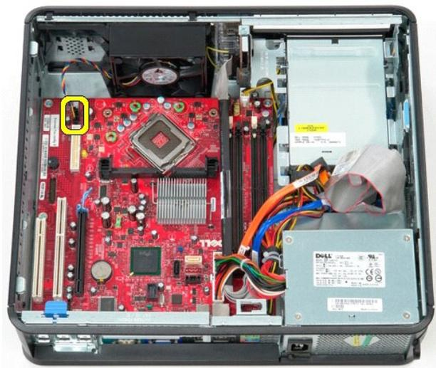
8. Desconecte el cable de alimentación de la placa base.
