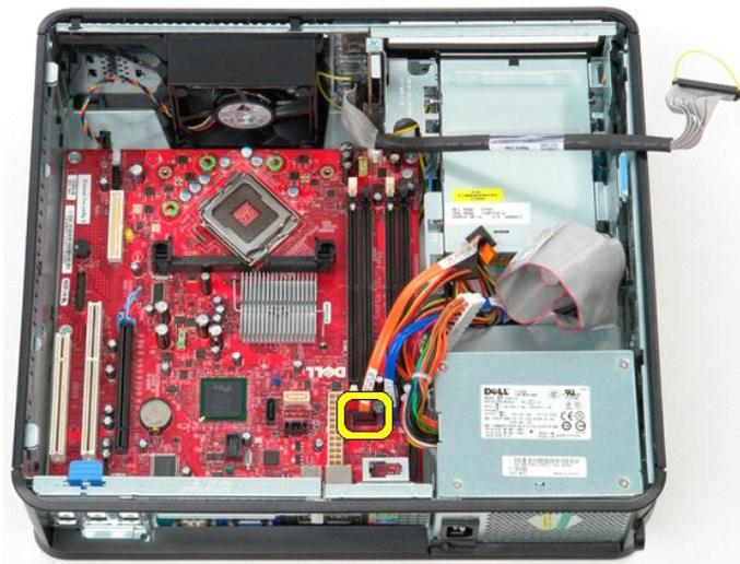
11. Desconecte el cable de datos de la unidad de disco duro de la placa base.
