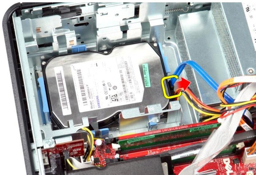
4. Desconecte el cable de alimentación de la unidad de disco duro.
