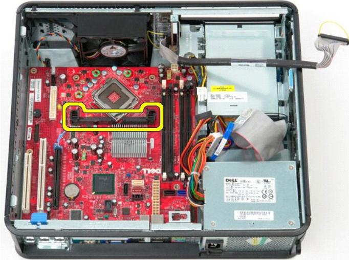
15. Para extraer la placa base, deslícela hacia la parte posterior del equipo y sáquela de éste.
